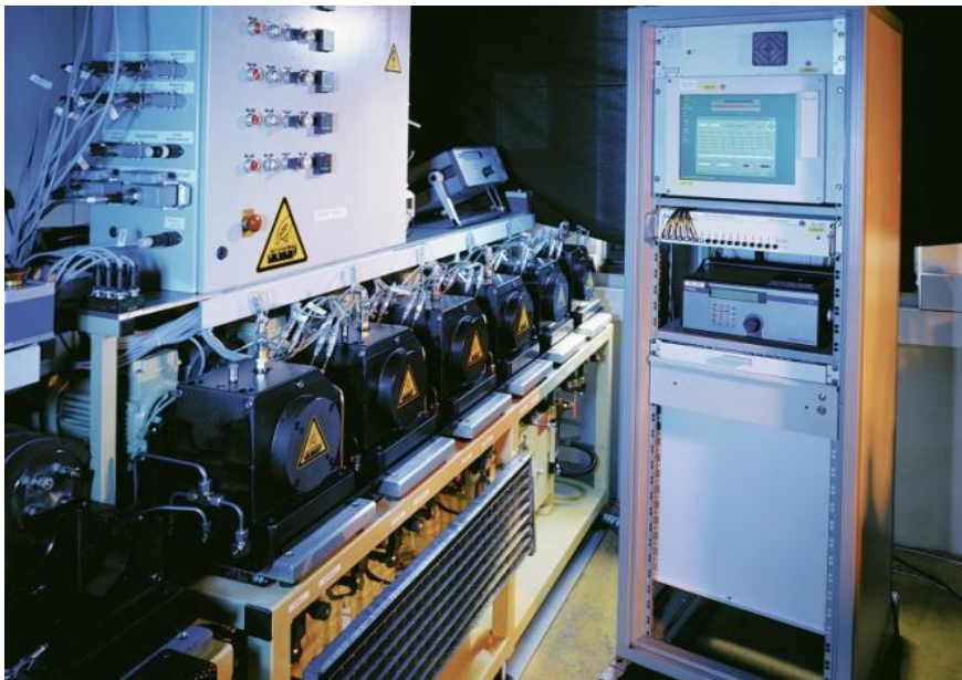
Abb.3: Radiallager im Dauertest: Lebensdauerprüfstand im Schaeffler Forschungs- und Entwicklungszentrum Herzogenaurach.
