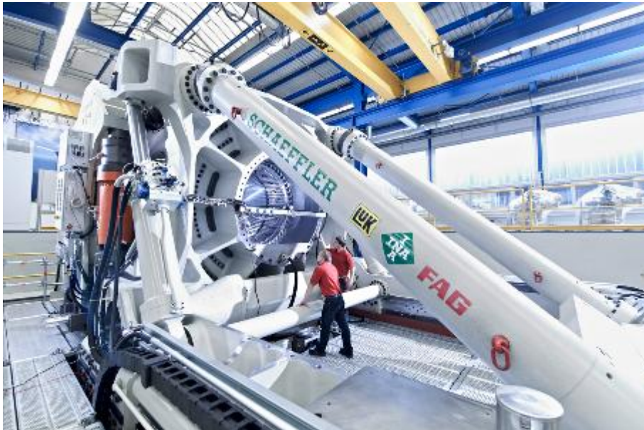
Abb.6: Mit seiner realitätsnahen Kraft- und Momentsimulation liefert Astraios seit 2011 wertvolle Erkenntnisse, die für die Neuentwicklung von Lagerlösungen sowie für die Optimierung der Simulations- und Berechnungsmodelle genutzt werden.
