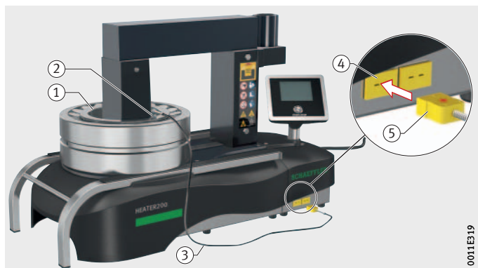
kép 41 Hőmérséklet-érzékelő csatlakoztatása és felhelyezése
